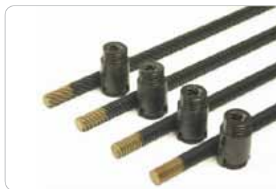
Obr. 3 Vodiace skrutky majú približne o polovicu nižšiu účinnosť ako gulôčkové tyče a majú aj obmedzenia pracovných cyklov. Sú ideálne pre vertikálne orientované aplikácie, ktoré by si inak vyžadovali brzdový mechanizmus.
