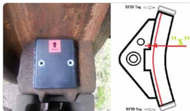
Obr. 5 Znáznornenie minimálnej hrúbky brzdového klátika a umiestnenia RFID tagu
