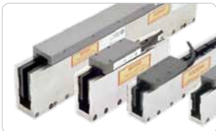
Obr. 6 Lineárne motory sú v podstate rozvinuté rotačné servomotory, ktoré sú priamo pripojené na záťaž. Ponúkajú vysokú presnosť, rýchlosť a zrýchlenie. Sú často cenovo nákladné.
