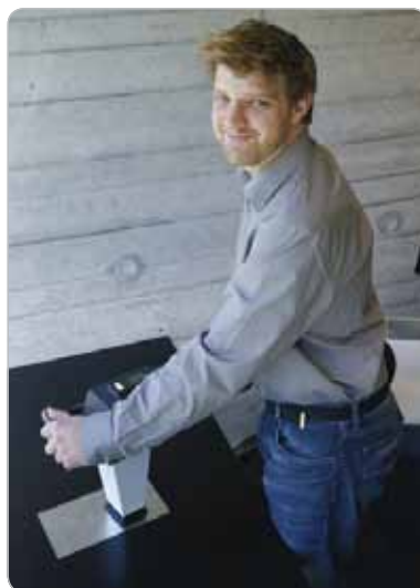
Obr. 2 Práca bez nutnosti používania ochranných okuliarov. Pokročilé bezpečnostné technológie, napr. SafeLOGIC-X, pomohli získať mobilným popisovacím laserom triedu 1 z hľadiska ochrany pri práci s laserom. Matthias Kauffmann pri zariadení TruMark 5010.
