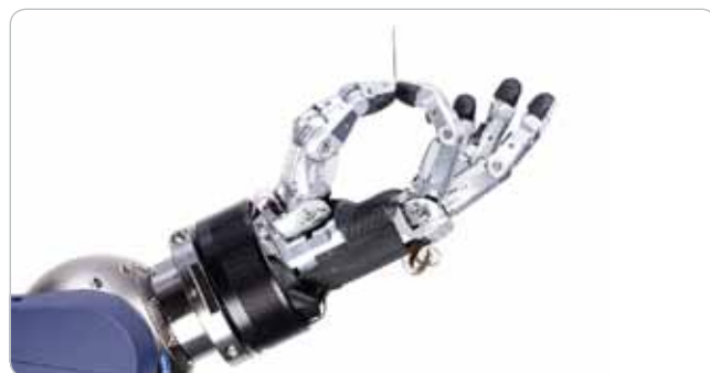
Obr. 3 V servisnej robotike otvára päťprstová uchopovacia ruka SCHUNK SVH nové dimenzie v uchopovaní a manipulácii. Tiež umožňuje komunikáciu človek – robot prostredníctvom giest.
