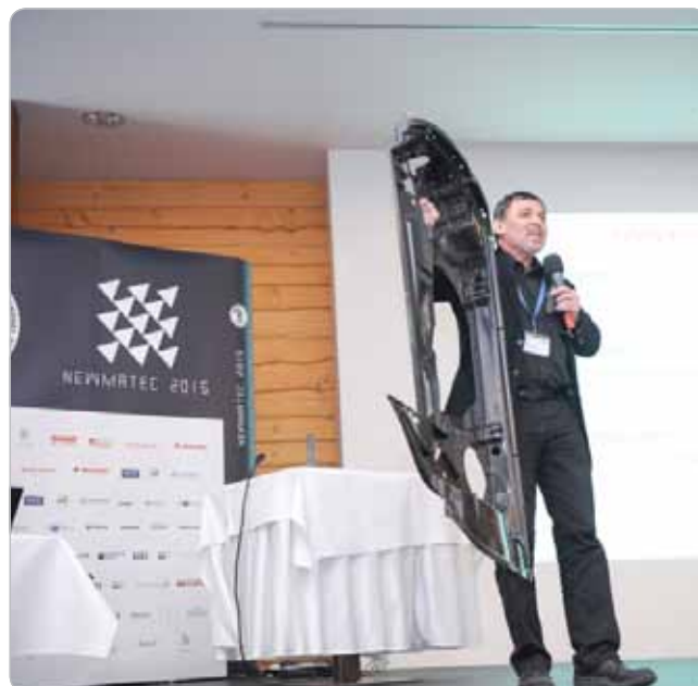
Obr. 6 Dr. Ing. František Simačík z Ústavu materiálov a mechaniky strojov SAV drží v ruke jednoliatu dverovú konštrukciu osobného automobilu vyrobenú z horčíka (foto: CoMS, s.r.o.)
