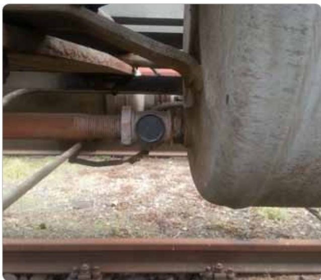
Obr. 7 Aplikácia RFID tagu TELID243 na tlakovej brzde
