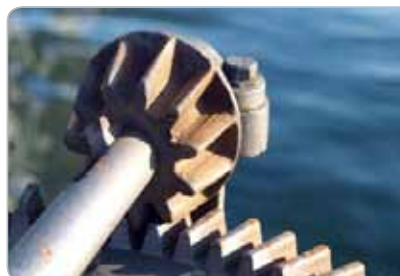
Obr. 5 Ozubený hrebeň a ozubené koleso sú ideálne pre mimoriadne dlhé dráhy pohybu. Avšak zvyčajne z hľadiska presnosti neponúkajú až tak veľa.
