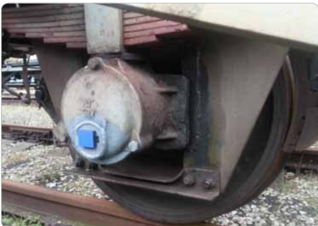
Obr. 8 Umiestnenie RFID tagu na prírupe ložiskovej komory
