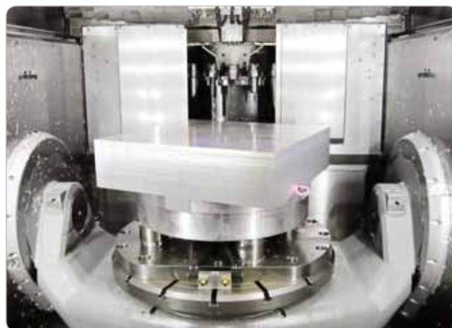
Obr. 2 Namiesto šiestich nastavení upínacích operácií sa teraz jednoliate kolesá v spoločnosti Thunderbike vyrábajú len pomocou troch nastavení upínacieho systému. Na to sa používa rýchlovýmenný paletový systém SCHUNK, ktorý prináša spoľahlivé upnutie a maximálnu presnosť.
