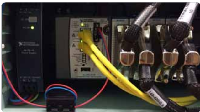
Obr. 2 Po inštalácii systému NI CompactRIO je možné získavať vzorky JTC kontrolnému bodu na diaľku zo všetkých koľajových obvodov na trati
