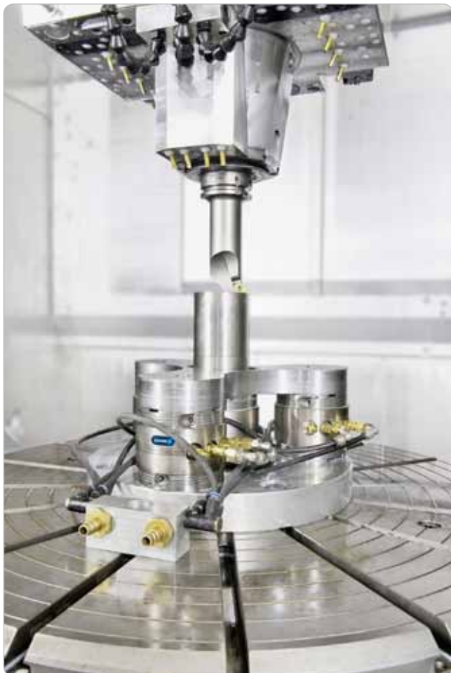
Obr. 4 Pri výrobe vzduchových valcov s priemerom do 60 mm používa H. Niehues špeciálne zariadenie, ktoré možno upnúť pomocou VERO-S v priebehu niekoľkých sekúnd.
