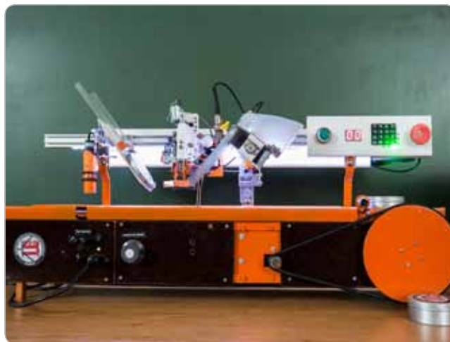
Obr. 2 Víťazný projekt SYGA 2014: Dávkovač matíc
