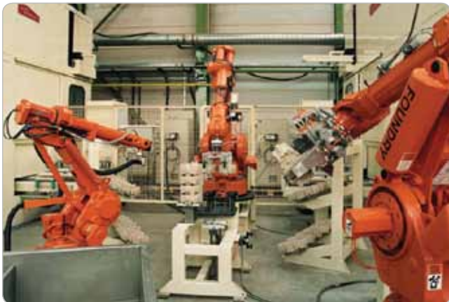
Obr. 1 Typické usporiadanie štíhlej robotickej bunky [7]
