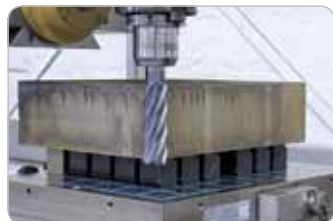
Obr. 1 Aplikácia MAGNOS: S platňami MAGNOS je obrobok bezpečne fixovaný a voľne prístupný z piatich strán.
