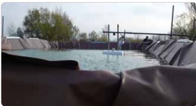
Obr. 1 Testovacia nádrž vytvorená z protipovodňových zábran
