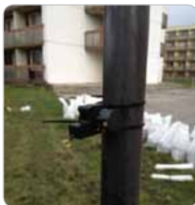
Obr. 4 Kovová konštrukcia na upevnenie lankového potenciometrického snímača polohy
