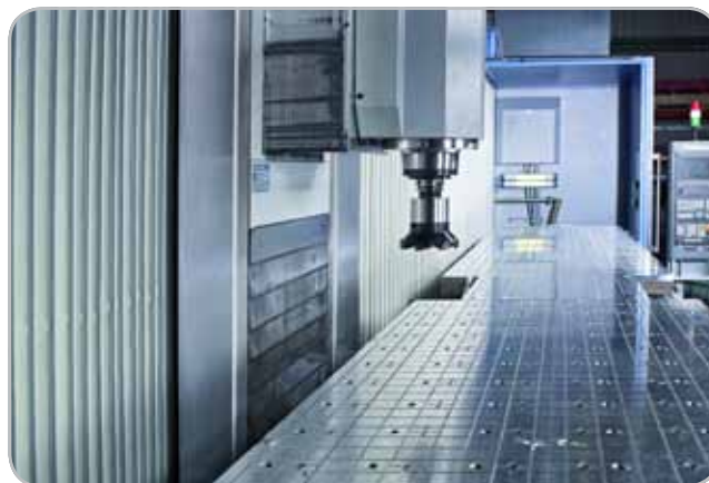
Obr. 2 PLANOS - letecký priemysel: Dlhé hliníkové komponenty sú upnuté bezpečne a bez deformácií s doskami PLANOS.
