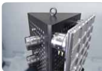
Obr. 4 Upínacie veže: Na priame upnutie na trojuholníkových vežiach umožňuje štandardný nadstavec VERO-S optimálny prístup.
