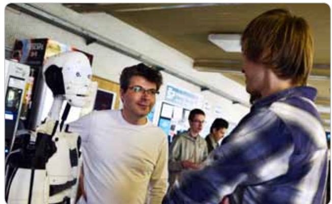
Obr. 3 Robot Alex InMoov je takmer celý vytlačený na 3D tlačiarňi
