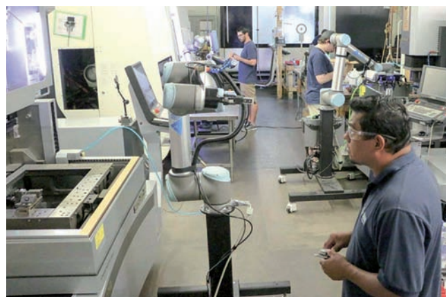
Za päť mesiacov bolo nainštalovaných päť kolaboratívnych robotov. Taký bol časový plán na zautomatizovanie viacerých činností v spoločnosti All Axis Machines.
