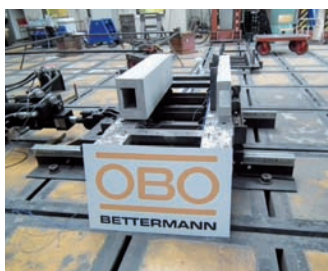
Seizmické skúšky kanála PYROLINE® Con a strmeňových príchytiek s kovovými rúrkami
