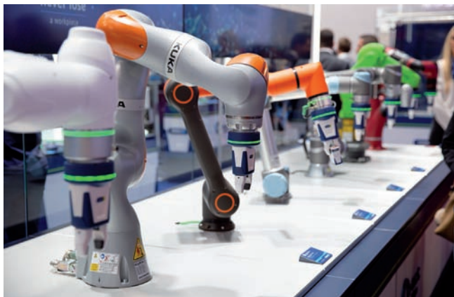
SCHUNK Co-act EGP-C, celosvetovo prvý priemyselný uchopovač s certifikáciou od DGUV, je štandardizovaný pre mnohé rozhrania cobotov.
