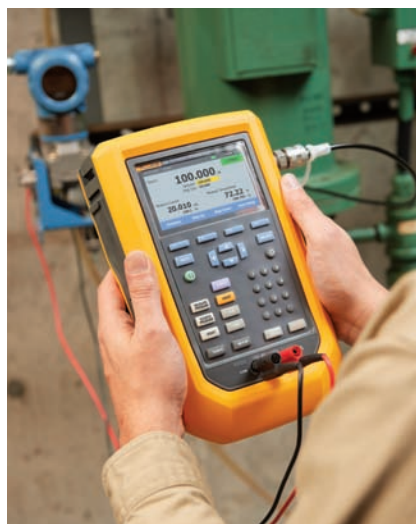
Ukážka kalibrácie HART prevodníka tlaku pomocou kalibrátora Fluke 729
