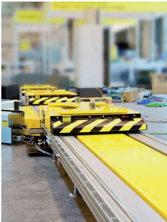
Systém e-Cart premiestňuje pohon a tým aj údržbu mimo dopravnej dráhy, čím sa maximalizuje jej dostupnosť.
