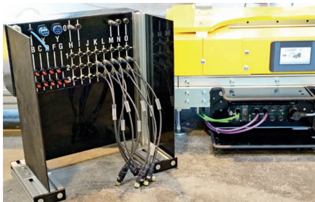
Pred a po: Riadiaci systém zabudovaný v puzdre Krups (vľavo) fungoval dobre, ale v porovnaní s modulom TBEN-L (vpravo) od spoločnosti Turck bol podstatne väčší, náročnejší na inštaláciu a fungoval len v sieťach Profinet.
