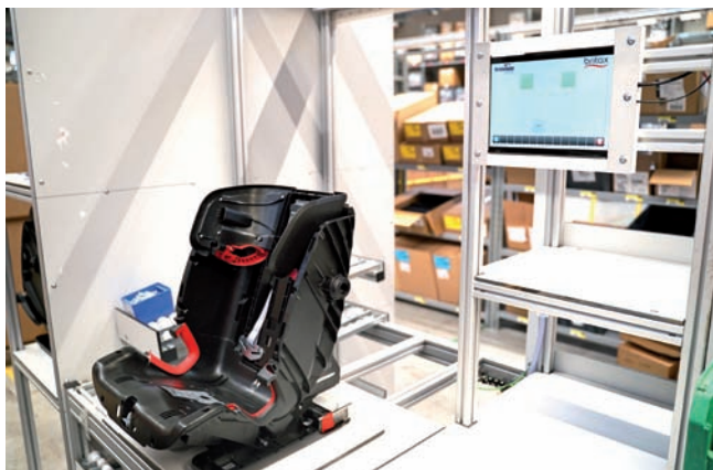
Na prvý pohľad: tablet (vpravo) na stanici prepracovania zobrazuje cez Labview, ktorá stanica sa má prepracovať.
