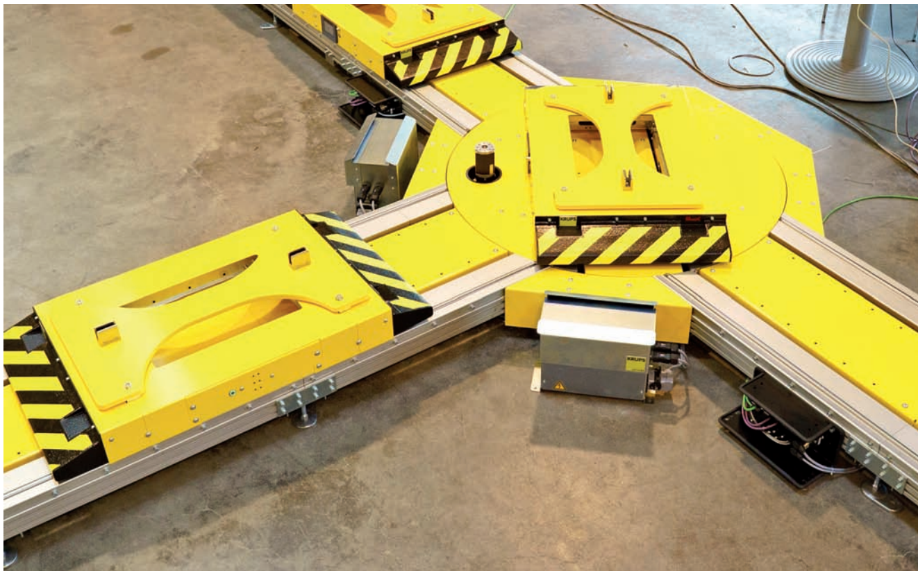
Na zarážkach a ďalších funkčných moduloch komunikuje systém e-Cart s vozíkmi cez NFC.
