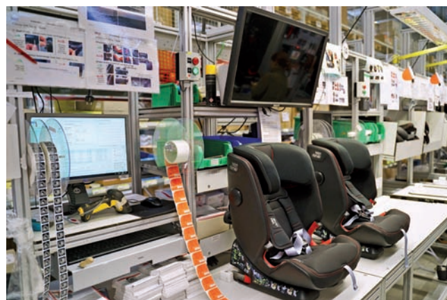
Predtým ako je sedadlo vybavené oranžovou nálepkou obsahujúcou sériové číslo, systém skontroluje, či sú všetky procesné stanice na sedadle označené ako OK.
