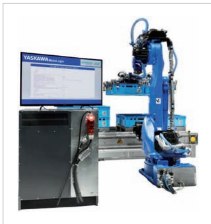
Pomocou softvéru MotoLogix možno roboty YASKAWA MOTOMAN rýchlo a ľahko programovať a ovládať pomocou PLC.
