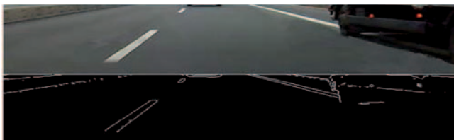
Obr.7 Pôvodný obraz a binárny obraz po aplikovaní hranového operátora
