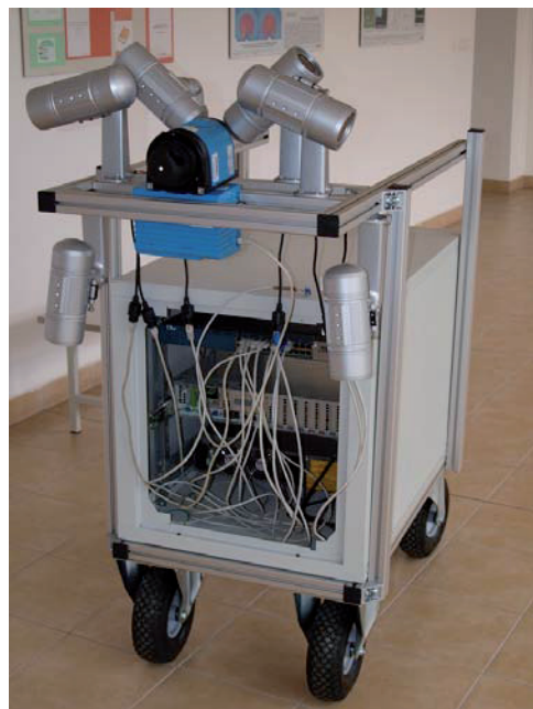
Obr. 1 Koncept meracieho vozíka, viditeľné sú kamery a obidva skenery
