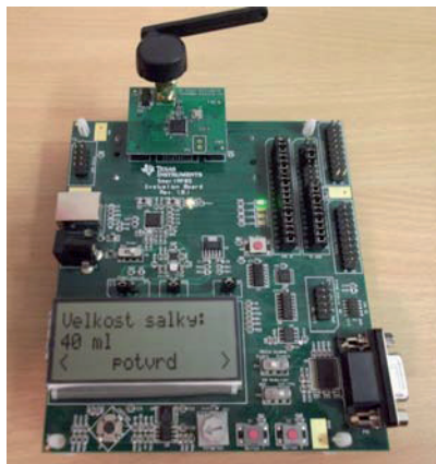
Obr.4 Displej v riadiacej jednotke kávovaru Fig. 4 Display in control unit of coffeemaker
