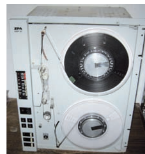
Obr. 25 Magnetická pásková pamäť CM 5311 uchováva dáta na 1/2" magnetickej páske.
