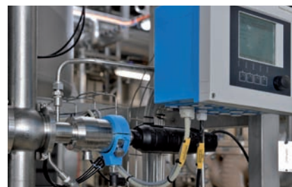
Inline meranie pH pomocou senzora bez skla CPA471D ISAFET; zasúvateľná zostava umožňuje čistenie a kalibráciu senzora bez prerušenia procesu.
