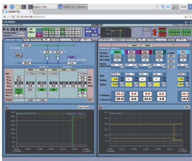
Dispečerská schéma LFC terminálu zobrazená v tenkom kliente Chromium na Raspberry Pi 2
