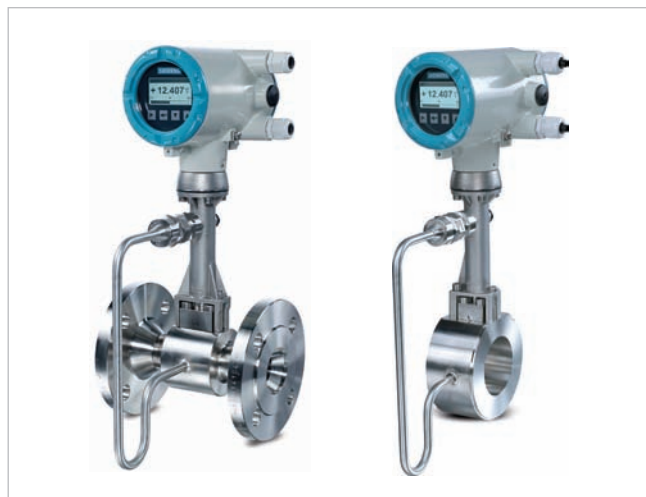
Nový prietokomer SITRANS FX330 integruje inteligenciu, odolnosť a spoločné meranie prietoku, tlaku a teploty. Prírubová verzia s online kompenzáciou hustoty (vľavo) a medziprírubová verzia s výhodou šetrenia miesta (vpravo).
