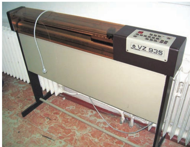
Obr. 24 Modernizované valcové kresliace zariadenie VZ 935
