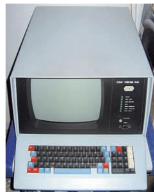
Obr. 18 Inovovaný abecedno-číslícový a grafový videoterminál SMEP CM 7202 M.1
