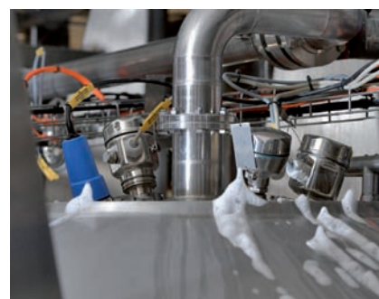
Prístroje na meranie výšky hladiny, teploty a vodivosti musia byť schopné odolávať externému čisteniu, ktoré sa vykonáva pri väčšine výrobných zariadení.
