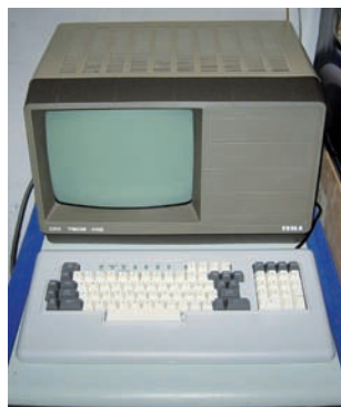
Obr. 19 Inovovaný abecedno-číslícový a grafický videoterminál SMEP CM 7202 M.2
