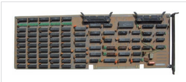
Obr. 21 PGA – doska grafickej pamäte grafickej stanice CM 1922
