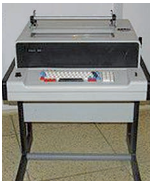
Obr. 20 Abecedno-číslícový mozaikový hard copy terminál SMEP CM 7108
