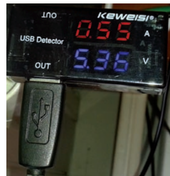
USB merač napätia a prúdu vložený medzi napájací zdroj a Raspberry PI 3 udával bežne spotrebu 0,6 A, v špičkách okolo 0,8 A.
