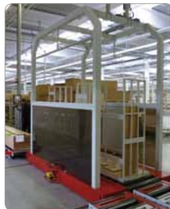
Obr. Presné polohovanie transportného stojana vrátane kontajnera na odovzdávacej stanici
