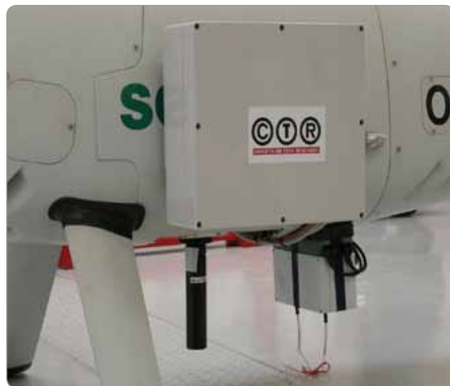
Obr. Kompaktné rozmery a nízka hmotnosť umožnili upevnenie počítača na konštrukciu bezpilotného lietajúceho objektu
