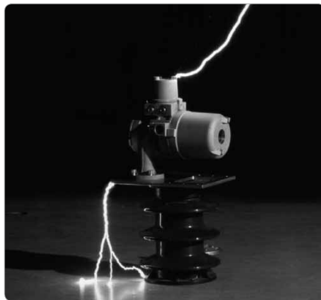
Obr. 20 Merací prístroj pri vysokonapäťovom teste
