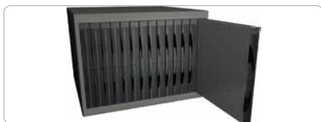
Obr. 7 Modularný a škálovateľný server „žiletka“ (blade server)
