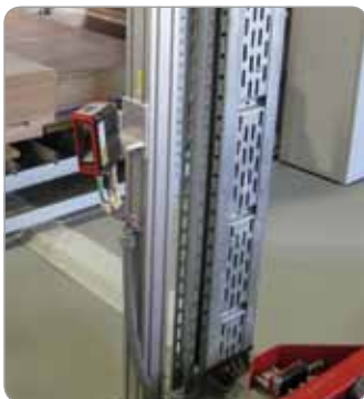
Obr. Stacionárna čítačka čiarového kódu BCL 504i na bočnom stĺpe
