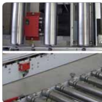
Obr. RFID čítací a zapisovací systém na čítanie diskového transpondéra integrovaného v kontajneri
