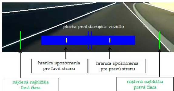
Obr. 7 Princíp návrhu detekcie prekročenia čiary Fig. 7 The principle of line crossing detection design
