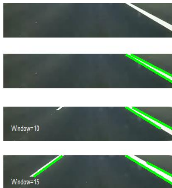
Obr. 12 Ilustrácia spracovávanej snímky bez (horný obrázok) a s použitím rôznych veľkostí plávajúcich okien
