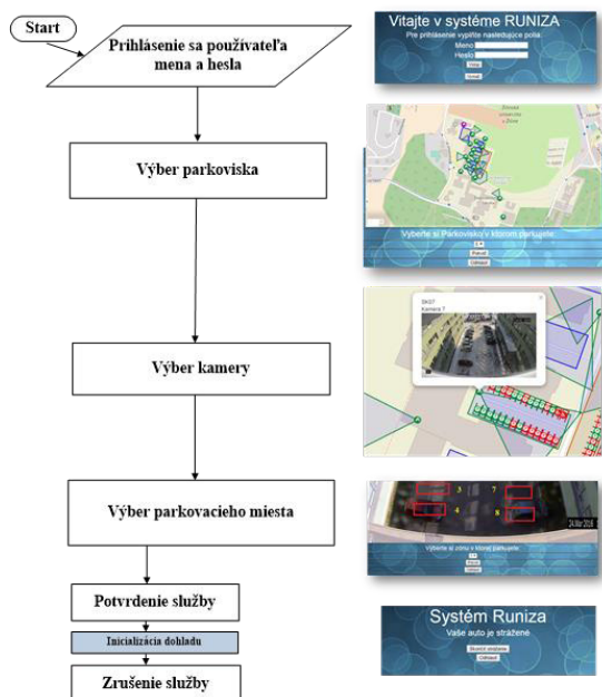
Obr. 3 Funkcionalita systému RUNIZA Fig. 3 Workflow of the RUNIZA system
