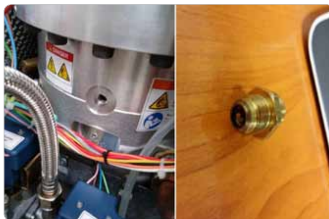
Obr. 8 Chybný ventil pracovného plynu SM
