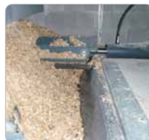
Obr. 6b posuvné podlahy v sklade drevnej štiepky
