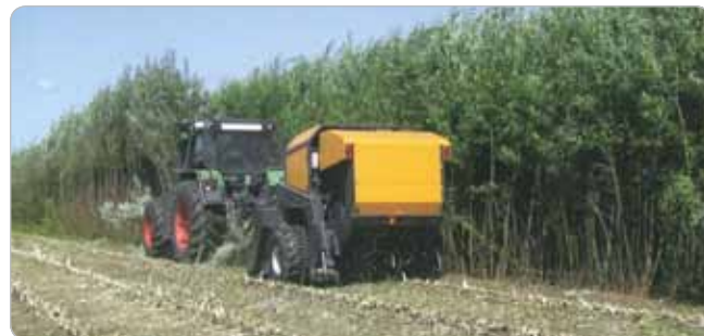
Obr. 8 Zariadenie na automatický zber vrb v praxi (zdroj: Anderson Group Co., Chesterville, Kanada - 2011)
