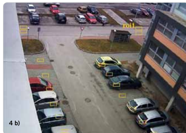
Obr. 4 a), b) Návrh rozmiestnenie slučiek medzi sledovanými sektormi (vľavo), príklad rozmiestnenia ROI v sledovanom sektore, zamerané na sledovanie pohybu (vpravo)
