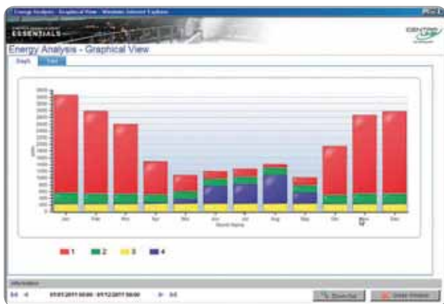
Obr. 4 Rozdělení energie v průběhu času; Legenda: 1: Vytápění (kWh), 2: Osvětlení (kWh), 3: Horká voda (kWh), 4: Chlazení (kWh)
