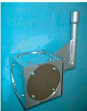
Obr.11 Konstrukce 3D snímače napětí (vlevo) se zobrazením označení 4 tenzometrů, tj. 4 měřicích kanálů
