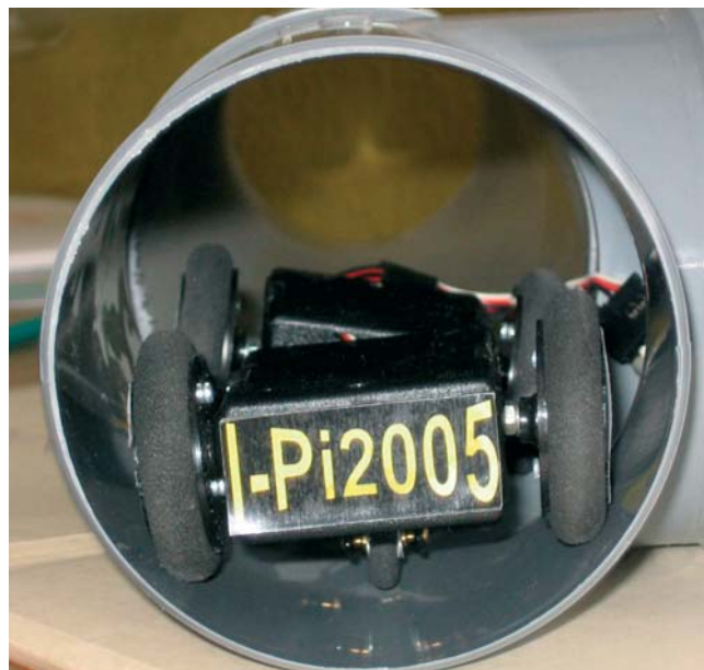
Obr.2 Potrubný stroj I-Pi2005 v potrubí s vnútorným priemerom 104 mm
