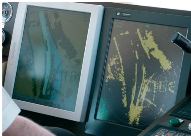
Monitory palubného počítača – porovnanie elektronickej navigačnej mapy (ENC) a radarového zobrazenia
